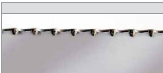
БИГОВАЛЬНАЯ ЛИНЕЙКА С ВОЛНИСТОЙ КРОМКОЙ толщина: 1,42 мм
