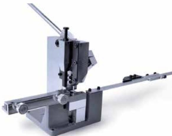
Станок режет два «усика» одновременно, а также придает небольшой угол на прямой части линейки, что способствует отличной стыковке. Смещению линейки препятствует специальная система прижима. Путем вращения двух винтов возможна регулировка для разных толщин линеек. Коленчатый рычаг способствует хорошей передаче усилия. Измерительный прибор позволяет резать длину линейки с высокой точностью.
